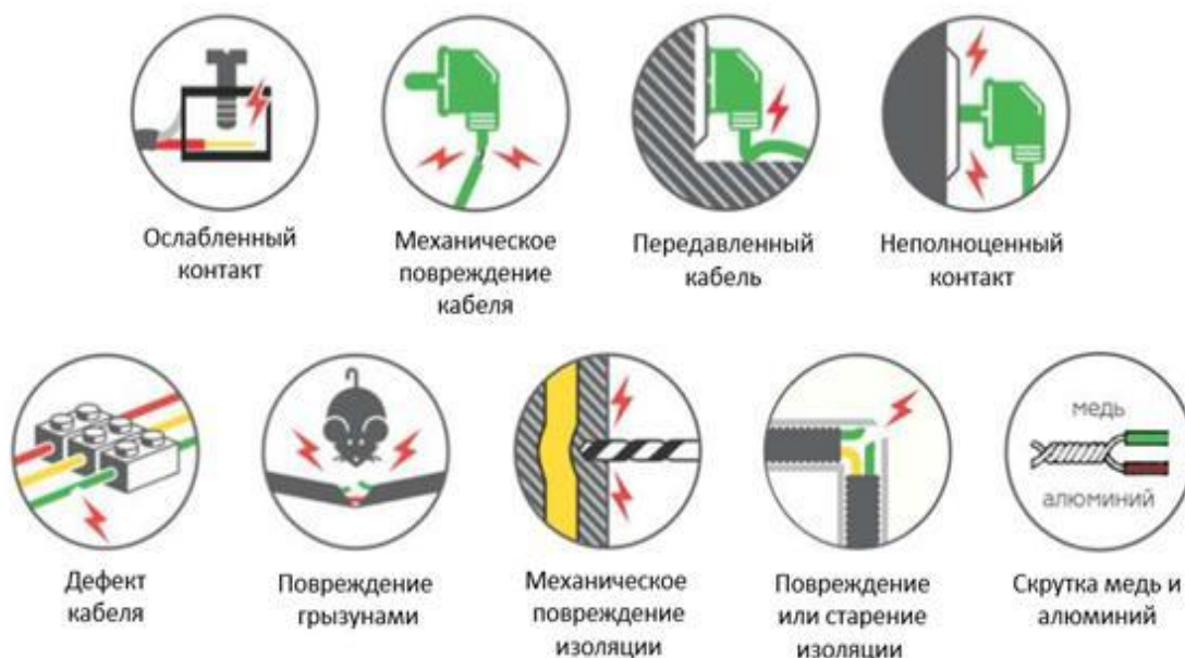
Рисунок 6. Возможные причины искрения в электропроводке
